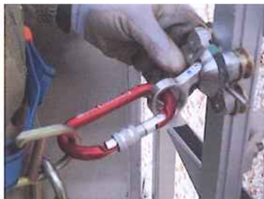
Carrello inserito correttamente (al centro a destra lo spinotto che impedisce l'inserimento scorretto; il lato alto al centro bollino verde)
