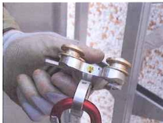
Lato inferiore del carrello con simbolo giallo di inserimento errato
