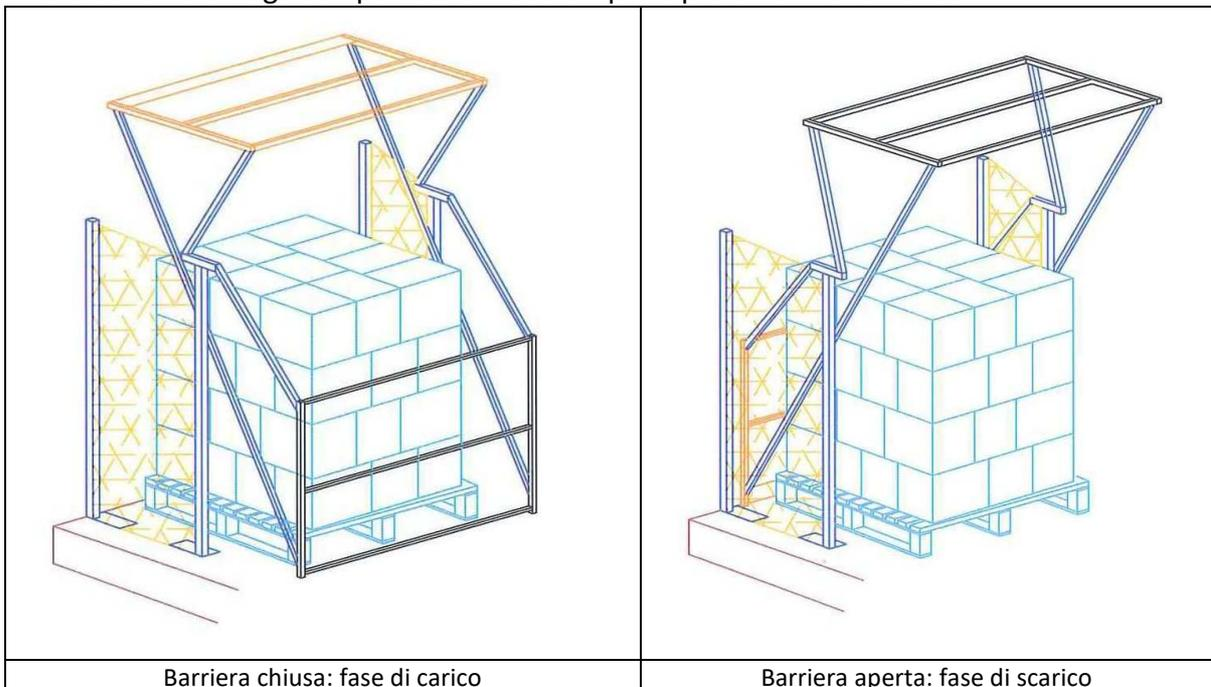
La figura seguente mette in evidenza il fatto che in fase di rotazione la barriera necessita di uno spazio di manovra sia superiormente sia verso il soppalco, da tenere in debito conto al fine di prevedere spazi liberi anche per la sicurezza dell'operatore.
