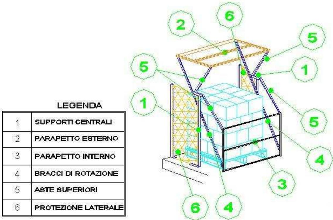
Nello schema di seguito riportato si illustra il principio di funzionamento.
