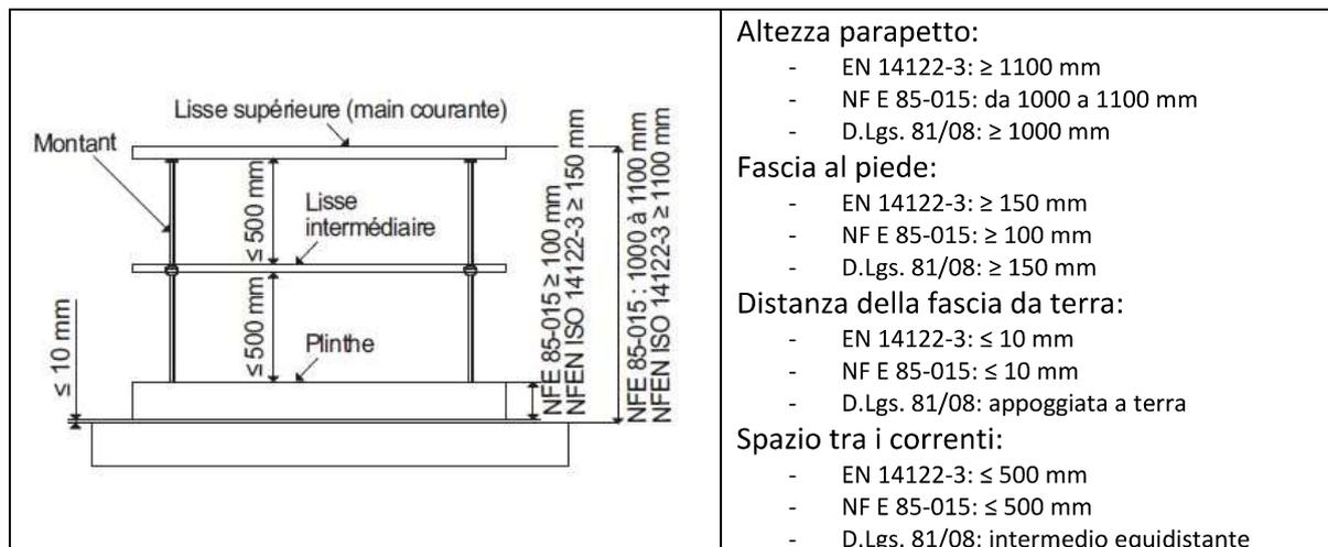
Si precisa inoltre che i **parapetti sono elementi con funzione di protezione anticaduta e sono preposti quindi alla sicurezza delle persone, ma non contribuiscono alla stabilità globale dell'edificio, pertanto non possono essere considerati elementi strutturali o elementi portanti.**
