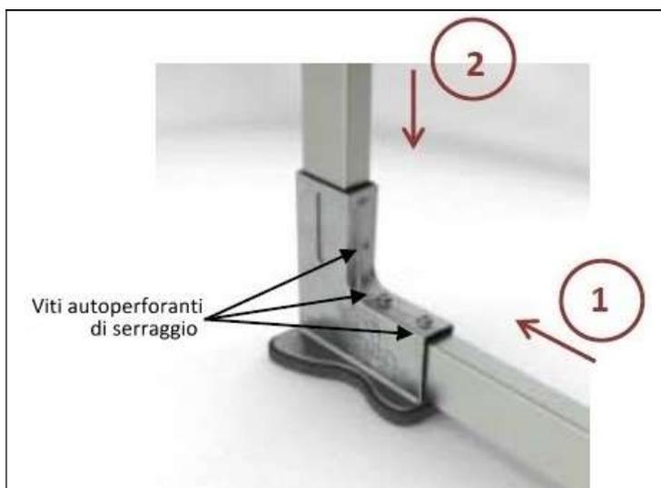
Figura 2: Montaggio del montante
