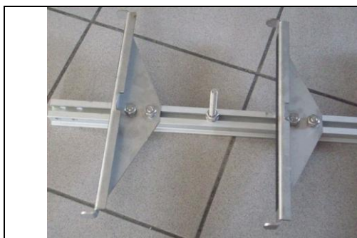
Vite inserita sulla scala
